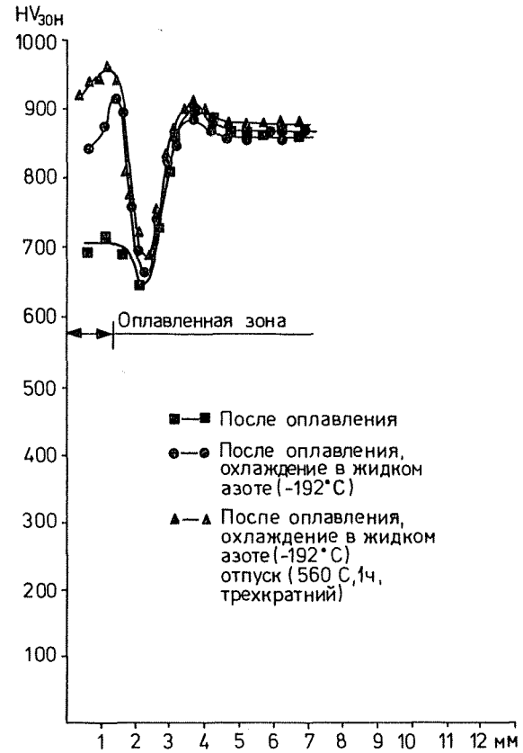
Рис. 7. Изменение твердости стали В12МФ4К5 в зависимости от термической обработки
